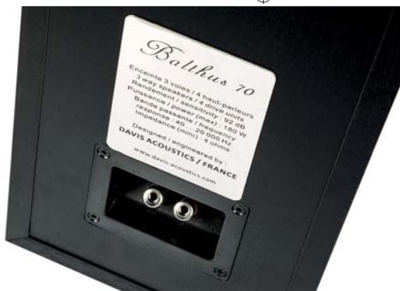
Davis trennt den Kevlartöner bei 400 Hz nach unten und bei 4 kHz zum Hochtöner hin. So werden die Übergänge zwischen den drei Chassis schön aus ebendiesem kritischen Hörbereich herausgehalten.
