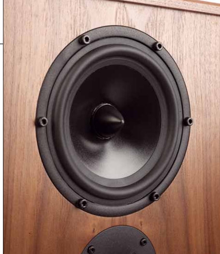
Der Mitteltöter hat zur Verbesserung der Linearität bei der Abstrahlung statt einer Dustcap einen festen Phase Plug innerhalb der Schwingspule
