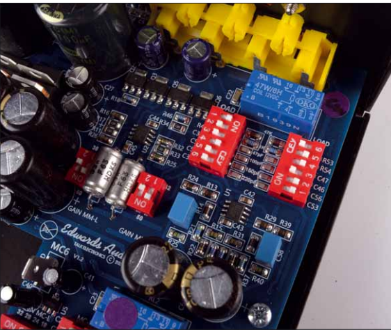
Man kann das Gerät in weiten Grenzen parametrieren, dafür gibt es acht DIP-Schalterblöcke auf der Hauptplatine
