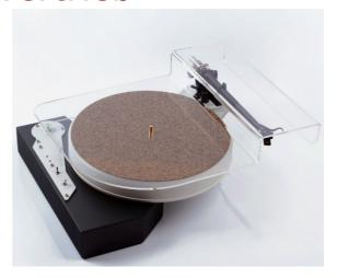
Der 40mm dicke und 2,4 kg schwere Teller wird aus Polypropylen mit sehr hoher Genauigkeit gefertigt und sorgt zusammen mit dem massiven invertierten Hauptlager mit Delrin Trust Plate (wie bei unseren fortgeschrittene Modellen) für eine gute Geschwindigkeitsstabilität
