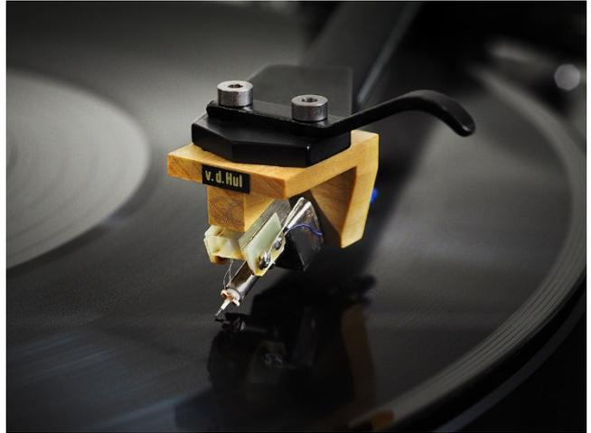
Der Colibri Grand Cru benötigt eine Auflagekraft von 1,35 bis 1,5 Gramm. Laut Aussage von Van den Hul ist es sogar möglich den Tonabnehmer mit einer Auflagekraft von nur 1,25 Gramm zu betreiben. Die Ausgangsspannung beträgt 0,5 mV, während die Lastimpedanz mit 120 Ohm bis 47 kOhm angegeben wird.
