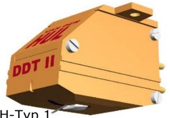
Ein klassisch von Hand gefertigtes Moving Coil Tonabnehmersystem mit vdH-Typ 1 Nadenschliff, Boron Nadelträger, langkristallinen Silberdraht-Spulen und 0,65mV Ausgangsspannung. Die Bezeichnung Special im Namen stellt nochmals die deutlichen Verbesserungen gegenüber dem Vorgängermodell heraus. So verfügt das DDT 2 Spezial über einen dickeren Frontpol und extra kleine Magnete. Beide Maßnahmen resultieren in gesteigertem Auflösungsvermögen und vergrößerter Ausgangsspannung.
