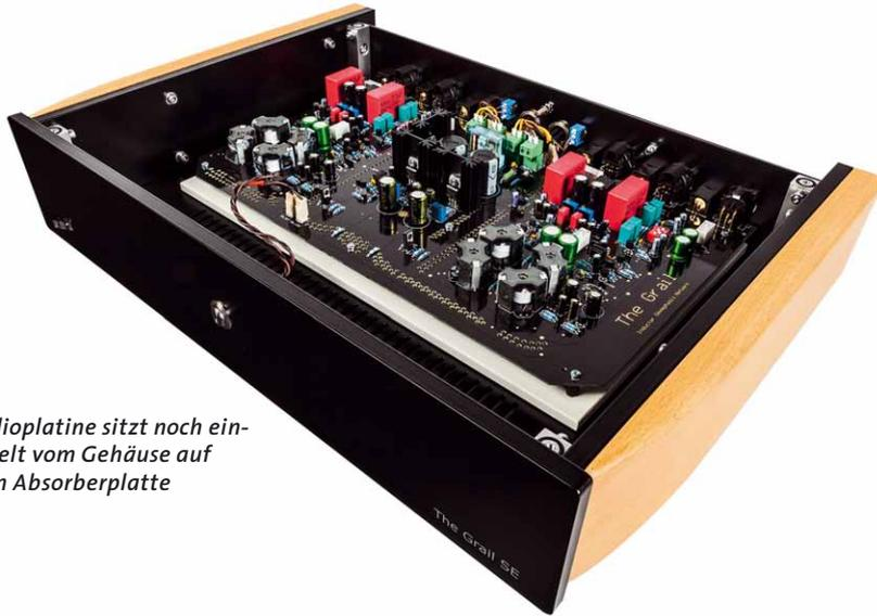
*Auch die Audioplatine sitzt noch einmal entkoppelt vom Gehäuse auf einer eigenen Absorberplatte*
