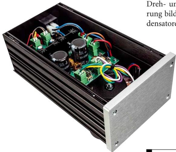
So aufwendig ist das Netzteil gebaut und trotzdem setzt man für beste Kanal-trennung zwei davon ein
