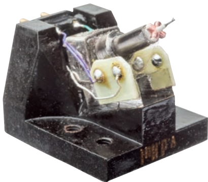
Durch den Verzicht auf das vordere Joch muss der verbleibende Magnet umso kräftiger sein, um die hohe Ausgangsspannung zu erreichen
