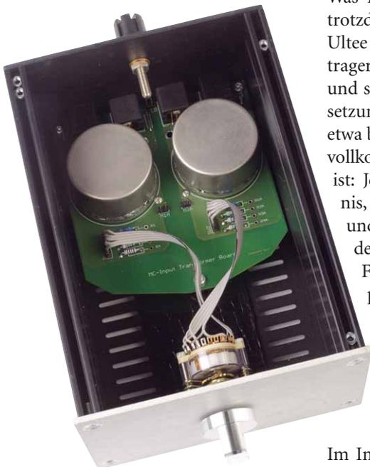
*Die MC-Übertrager fertigt der Entwickler selbst*
