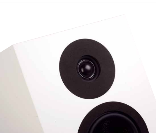
Der Hochtöner hat eine 28mm-Gewebemembran und setzt bei 2,5 kHz ein
